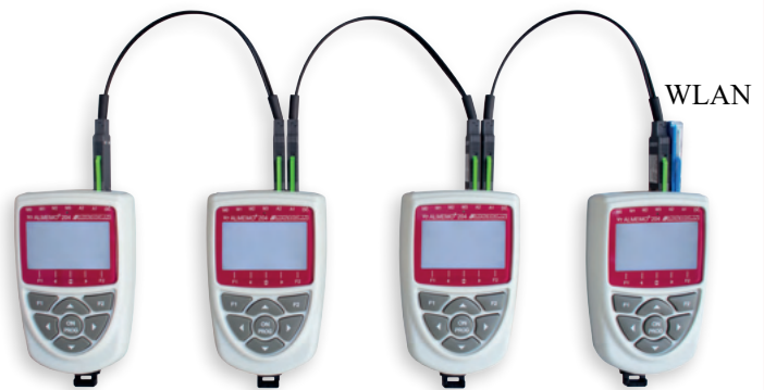
Réseau câblé, jusqu'à 99 appareils, jusqu'à 50 m de longueur de câble
