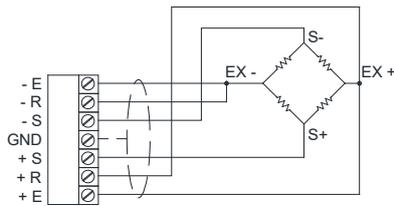
CONNEXION CAPTEURS À 4 FILS
