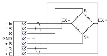
**CONNEXION CAPTEURS À 4 FILS**
