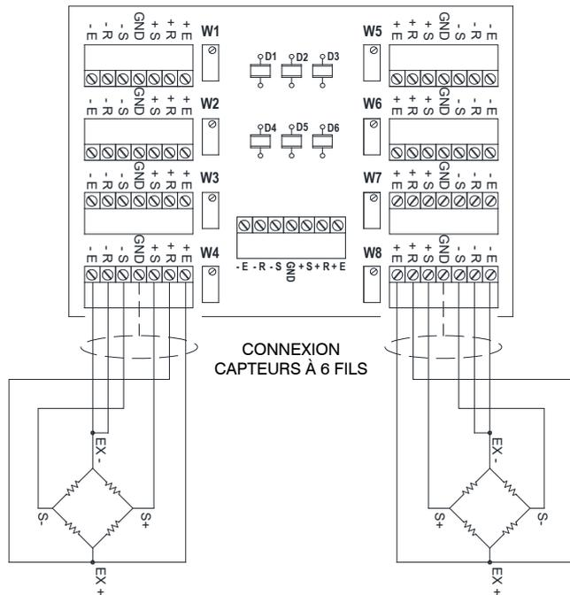
**CONNEXION CAPTEURS À 6 FILS**
