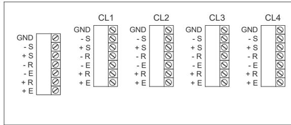
CONNEXION CAPTEURS À 6 FILS
