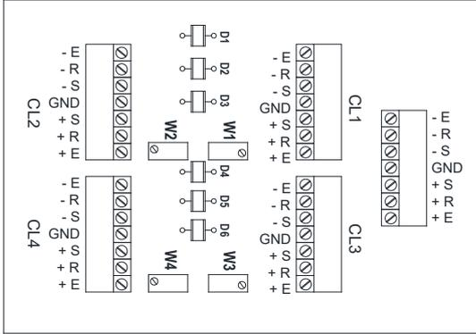
CONNEXION CAPTEURS À 6 FILS
