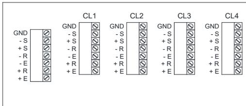
CONNEXION CAPTEURS À 6 FILS
