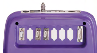
VUE ARRIÈRE AVEC CONNECTEURS D-SUB (IP40)
