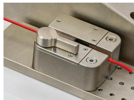
▲ La pince à coin autobloquante standard maintient et tire fermement l'extrémité libre du câble.
