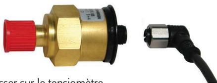
À visser sur le tensiomètre avec câble de raccordement ALMEMO®, longueur 7m.
