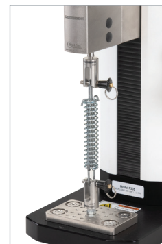
Test de traction de ressort
