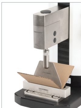
Test de pliage d'emballage
