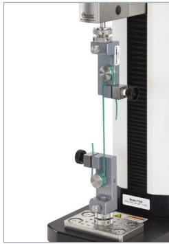
Test en traction sur cordon ou câble
