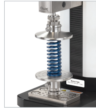
Test de compression de ressort
