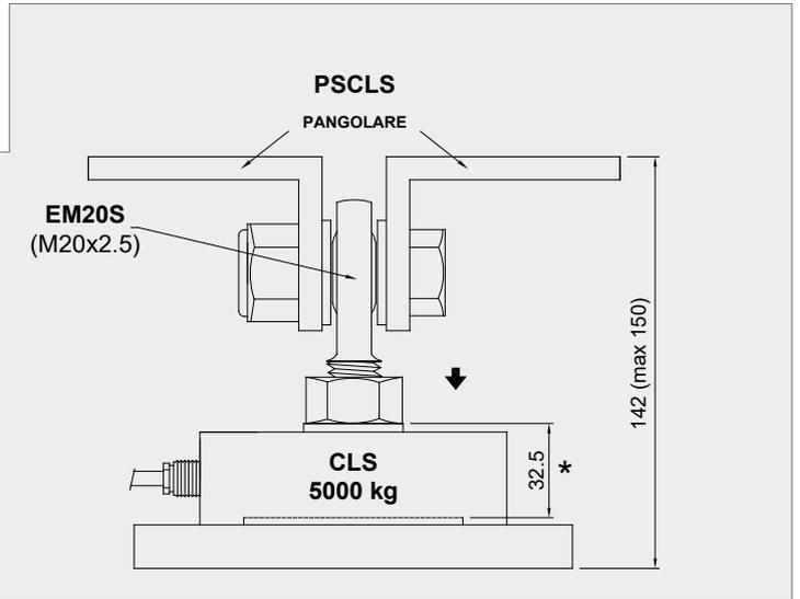
\* ATTENTION! Cote maximale de l'insertion de boulon pour le bon fonctionnement du capteur
