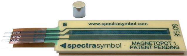
Disponibles en versions angulaires ou linéaires, ces capteurs de position potentiométriques sans contact ont une étendue de mesure allant de 12,5 mm à 1000 mm en plusieurs gammes pour les déplacements linéaires et d'un diamètre de 35 mm pour les capteurs angulaires. Quasiment inusables, puisque sans contact (>1 million de cycles), ils ont un indice de protection IP64. Ces capteurs de position sont très faciles à mettre en œuvre grâce à un adhésif type 3M.
