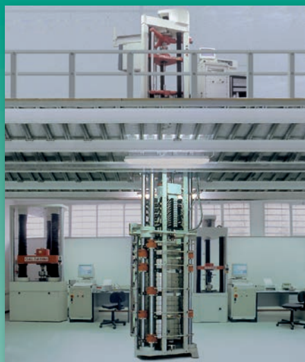
Macchine campione di forza a pesi diretti. Dead-weight force sample machines.
