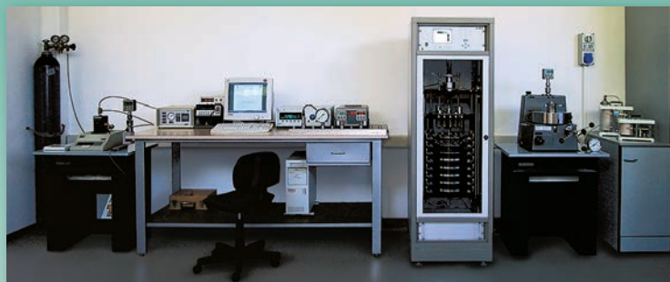
Banco torsionometrico a pesi diretti con guida ad aria. Dead-weight torque bench with air bearing.
