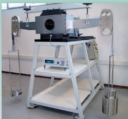
Banco torsionometrico a pesi diretti con guida ad aria. Dead-weight torque bench with air bearing.
