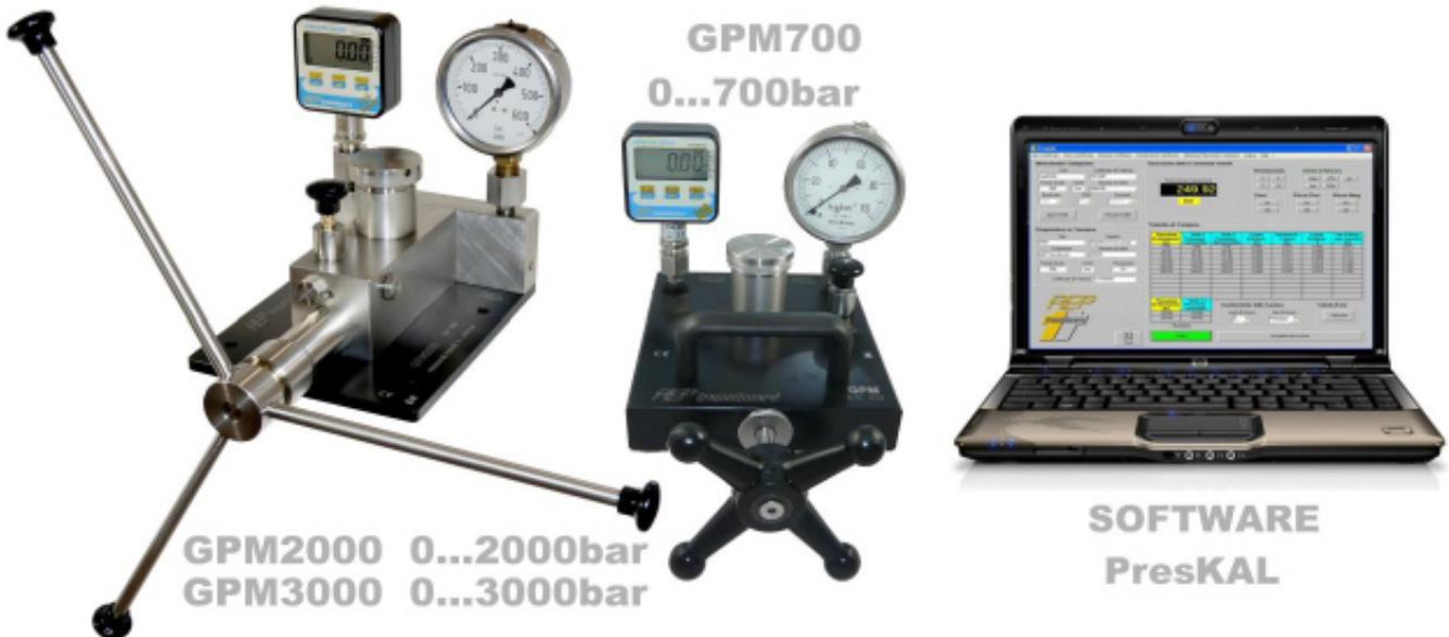
Les générateurs de pression manuels sont utilisés pour comparer les mesures entre le manomètre de référence et l'instrument à étalonner. Ils constituent une solution idéale pour les étalonnages et les confirmations métrologiques de manomètres tels que les jauges de pression, les transducteurs et les transmetteurs de pression et les commutateurs de pression.
