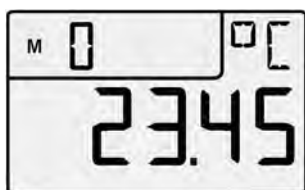
Affichage de valeur de mesure canal M0 température
