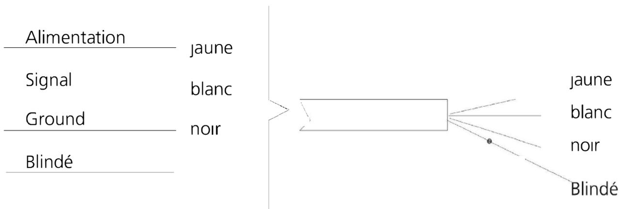
La blindage du câble doit être connecter au blindage de l'appareil (blindage h.f.). Si l'appareil n'a pas de blindage, le câble blindé du capteur doit être connecter à la masse de l'appareil.
