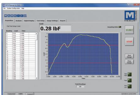
▲ Afficher les données en temps réel sous forme de graphique et format tableau. Possibilité de tarer le dynamomètre ou la mesure de déplacement du banc d'essai via le logiciel.
