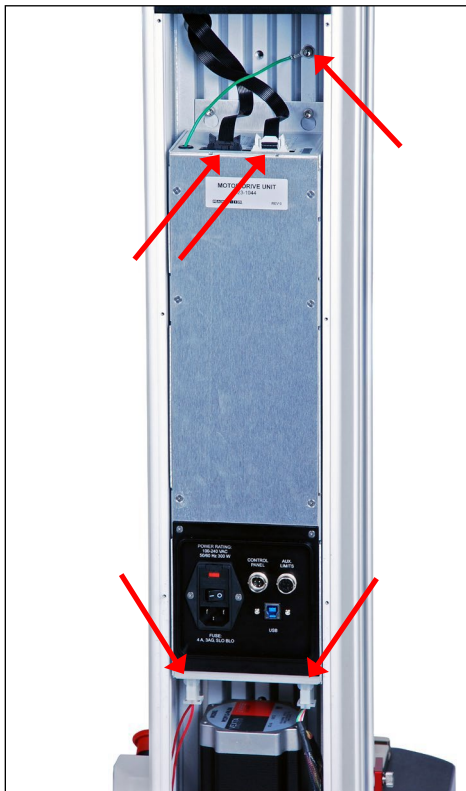
Emplacement des connecteurs, fil de terre et support
