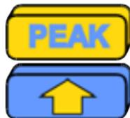
Pendant la mesure, maintenez-la enfoncée pendant 1 seconde pour activer la fonction PIC+ (affiche la force MAXIMUM relevée après l'activation de la fonction).
