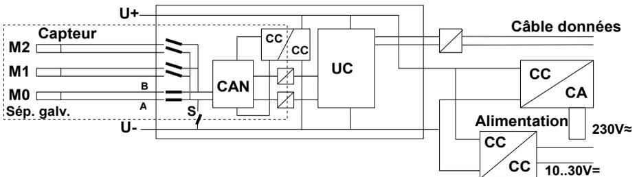
Les entrées analogiques sont séparées galvaniquement les uns des autres par relais photovoltaïques. Nouveauté sur cet appareil, la séparation supplémentaire des entrées de mesure par rapport à l'UC et à l'alimentation. Entre toutes les entrées et sorties (même les câbles de sortie analogique sans séparation galvanique), une différence de potentiel maximum de 50 V est admissible. La tension entre les entrées de mesure elles-mêmes (entre B, C, D et A) ne doit pas dépasser 12 V !
