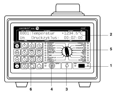
(1) **INTERRUPTEUR** à bascule pour METTRE SOUS TENSION l'appareil
