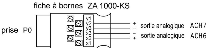
Les canaux de mesure édités sur chaque sortie analogique respective se configurent sur l'afficheur (voir 11.2) ou sur l'interface (voir manuel 6.10.7). Pour atteindre la meilleure résolution, la plage partielle utilisée peut être étendue à la plage de sortie complète (0..10V ou 0/4..20mA) (voir 11.2, manuel 6.10.7).
