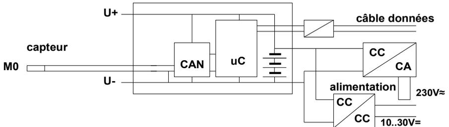
Les capteurs combinés sur un connecteur et les capteurs avec alimentation sont reliés galvaniquement et doivent donc être utilisés de manière isolée. La tension entre les entrées de mesure elles-mêmes (entre B, C, D, A ou -) ne doit pas dépasser 5 V !
