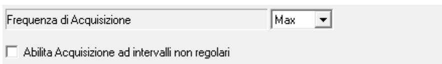
Pour les tests particulièrement longs, il est conseillé de diminuer le temps d'acquisition afin d'éviter la création de fichiers trop volumineux. Si l'on sélectionne «Max», la fréquence d'acquisition réelle dépendra des caractéristiques de l'instrument et de la vitesse de transmission paramétrée.
