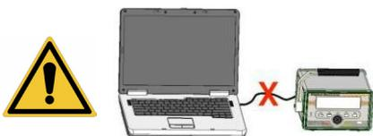
Avec la sélection du type de stockage en mémoire flash (USB), la communication USB avec le PC est automatiquement désactivée.
