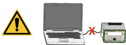
Lors de la sélection du type de DATALOG sur USB FLASH MEMORY, la communication USB avec le PC est automatiquement désactivée.
