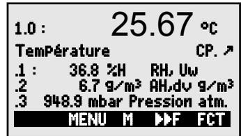
Des fonctions de mesure supplémentaires peuvent être réalisés à l'aide de menus de fonction (voir 14).
