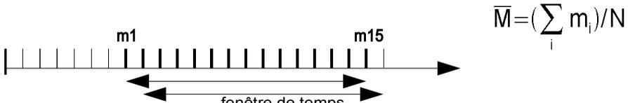
Stabilisation de la mesure par ex. sur 15 valeurs par: **Lissage :** 15
