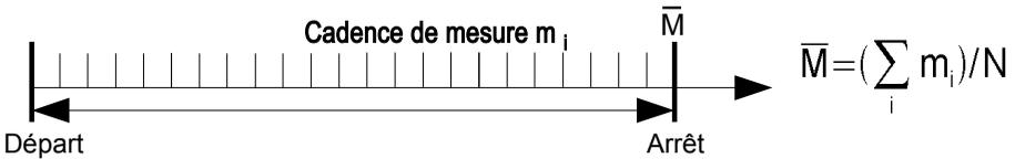
Effacer moyenne et durée de mesure automatiquement au départ (voir 16.9) ou après sélection de la moyenne avec : **<CLR>**
