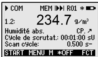
Saisie du cycle de sortie, U sortie actif : **Cycle de sortie : 00:10:00 s U**
