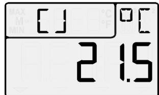
Température de soudure froide
