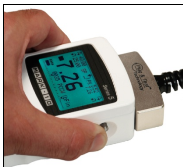
Fig 3.2 Pour libérer le connecteur Plug & Test™, appuyez sur les deux boutons de chaque côté du boîtier de l'afficheur.
