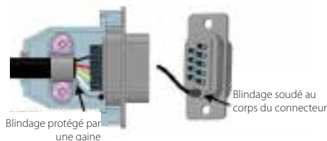
DB9 femelle vue latérale de la soudure
