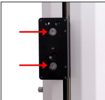
2. Installez le support de l'indicateur sur le côté de la traverse, en utilisant deux vis à tête plate n°10 à 32, tel que représenté sur l'image ci-dessous :
