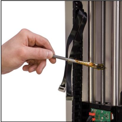
4. Entamez le cycle de la traverse vers le haut et vers le bas à plusieurs reprises jusqu'à ce que la graisse récemment appliquée se répande uniformément sur la longueur de la vis.
