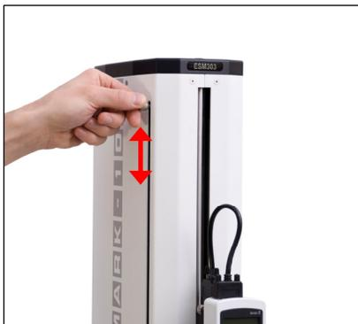
Les interrupteurs de fin de course permettent à l'opérateur de définir un emplacement le long de la colonne où la traverse cesse de se déplacer. Les interrupteurs de fin de course sont situés sur le côté gauche de la colonne du banc d'essai, comme indiqué sur l'image de gauche. Réglez leurs positions en desserrant, en repositionnant et en resserrant les vis de serrage.
