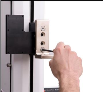
4. Montez la cellule de charge pour le support en L en utilisant le matériel inclus.
