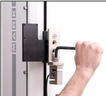
5. Montez l'indicateur en utilisant les quatre vis de serrage fournies, et branchez le raccordement Plug & Test™ dans l'indicateur. Orientez le boîtier de l'indicateur de telle sorte que le raccordement soit dirigé vers le bas. Reportez-vous au guide de l'utilisateur de l'indicateur pour plus de détails.
