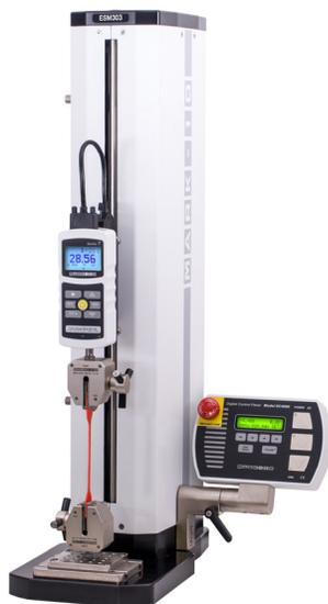
Merci d'avoir acheté un Banc d'essai de force Mark-10, modèle ESM303, conçu pour produire jusqu'à 300 lbF (1,5 kN) de force de tension et de compression. Le modèle ESM303 constitue le composant indispensable du système d'essai de force : il se compose généralement d'un dynamomètre de traction ou un capteur dynamométrique doté d'un capteur et des éléments de serrage.
