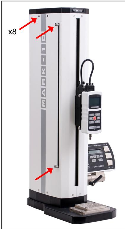
3. La plaque d'appui électronique contient la plupart des composants électroniques du banc d'essai, et doit être retirée pour pouvoir accéder à la zone requise. D'abord, enlevez les six vis identifiées sur l'image ci-dessous. **N'écartez pas** la plaque de la colonne, car des mesures supplémentaires sont nécessaires pour le retrait.
