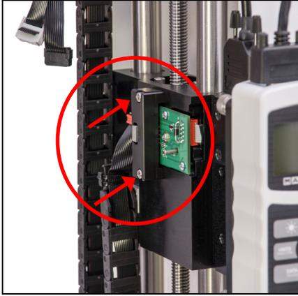
7. Réinstallez le matériel et les composants dans l'ordre inverse. Assurez-vous de positionner l'interrupteur de fin de course supérieur au-dessus de la traverse et l'interrupteur de fin de course inférieur en dessous de la traverse avant d'installer la plaque de support des éléments électroniques.
