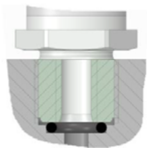
Étanchéité O-RING pour pressions <1000bar
