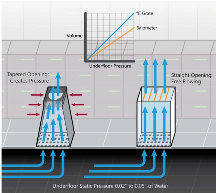
La précision du balomètre est affectée par la contre-pression qu'il transmet au système de carrelage. Le pourcentage d'erreur est fonction du profil de pression du sol.
