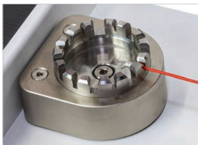
▲ Le carrousel comprend plusieurs fentes permettant de fixer des fils jusqu'à Ø 6,3mm
