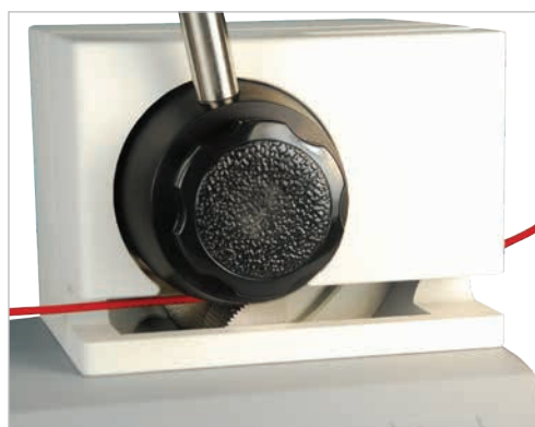
▲ La conception unique de la tige à molette permet de fixer et de tirer efficacement l'extrémité libre de l'échantillon.
