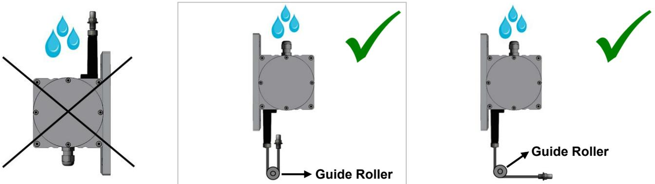
4. Le câble ne doit pas être tiré en biais. Si nécessaire, utilisez des rouleaux de guidage.
