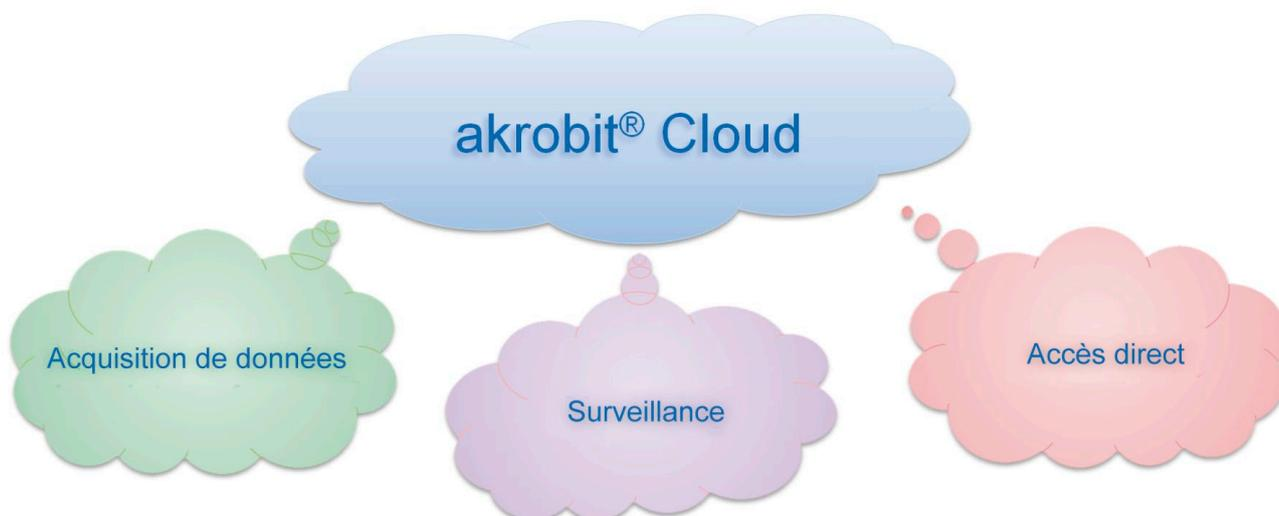
L'acquisition des données de mesure s'effectue par le serveur en nuage akrobit® Cloud Server, qui scrute les données sur les appareils de mesure, les enregistre et les met à disposition au téléchargement ou par courriel dans différents formats. Pour l'affichage et l'évaluation (par ex. avec canaux de calcul), RMT
