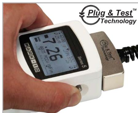
^ Le connecteur Plug & Test se verrouille dans le réceptacle de l'indicateur lorsqu'il est complètement inséré. Deux boutons de déblocage du PTA du logement de l'afficheur permettent un retrait facile. Les contacts plaqués or assurent connexion parfaite avec une longue durée.
