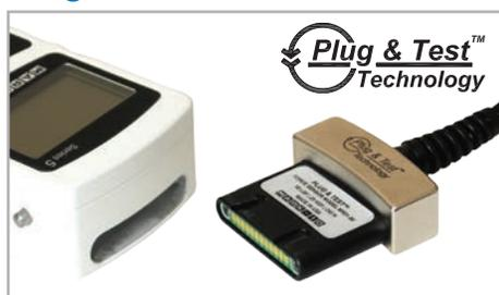
^ La technologie unique Plug & Test permet l'interchangeabilité des capteurs pouvant être utilisés avec un indicateur 7i, 5i ou 3i. L'étalonnage et les données de configuration sont enregistrés dans le connecteur intelligent PTA.
