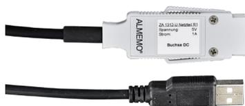
Câble d'alimentation ALMEMO® avec prise USB. NON galv.getr., 5 V DC via une banque d'alimentation USB ou PC. Fiche USB avec câble de 1,5 m et fiche d'alimentation ALMEMO® ZA 1312-FS8. Pour les appareils ALMEMO® (à partir de 2014) 2490, 2470, 2590-2A/4AS, 2690, 202-S, 204
